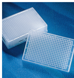
384ウェルポリプロピレン製ストレージマイクロプレート
